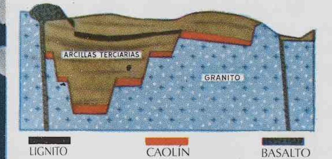
Fig. 5.- Esquema de un depósito europeo de caolín.
