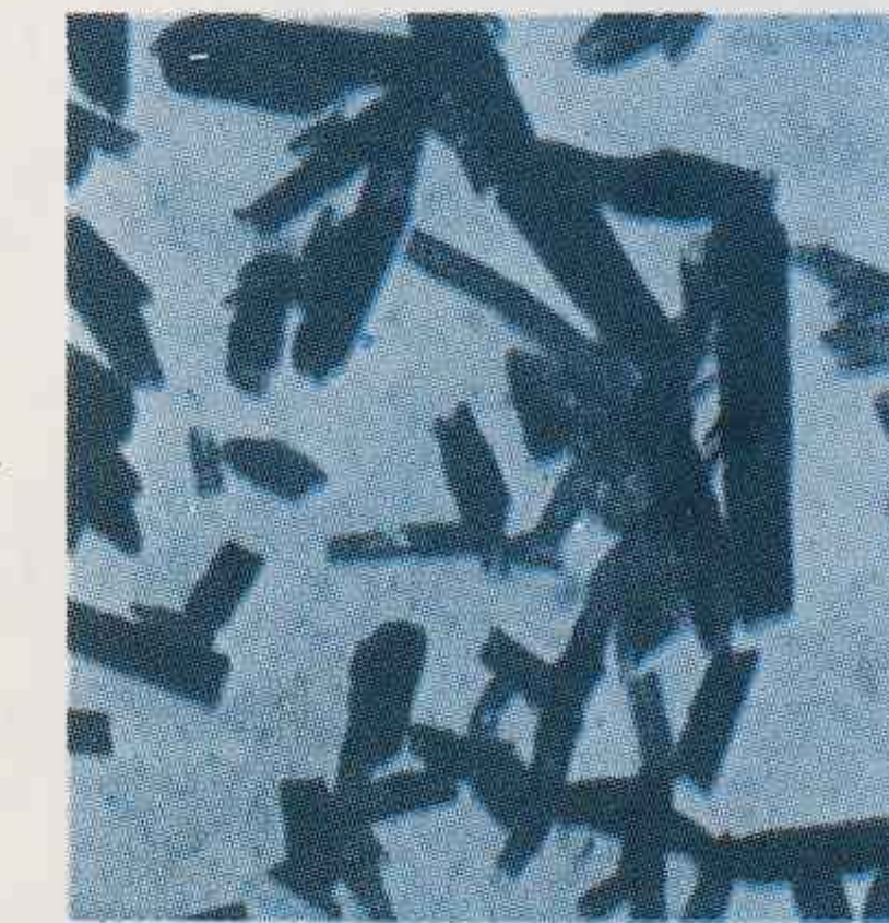
Fig. 6.- Fotografía con microscopio electrónico de cristales de halloysita.
