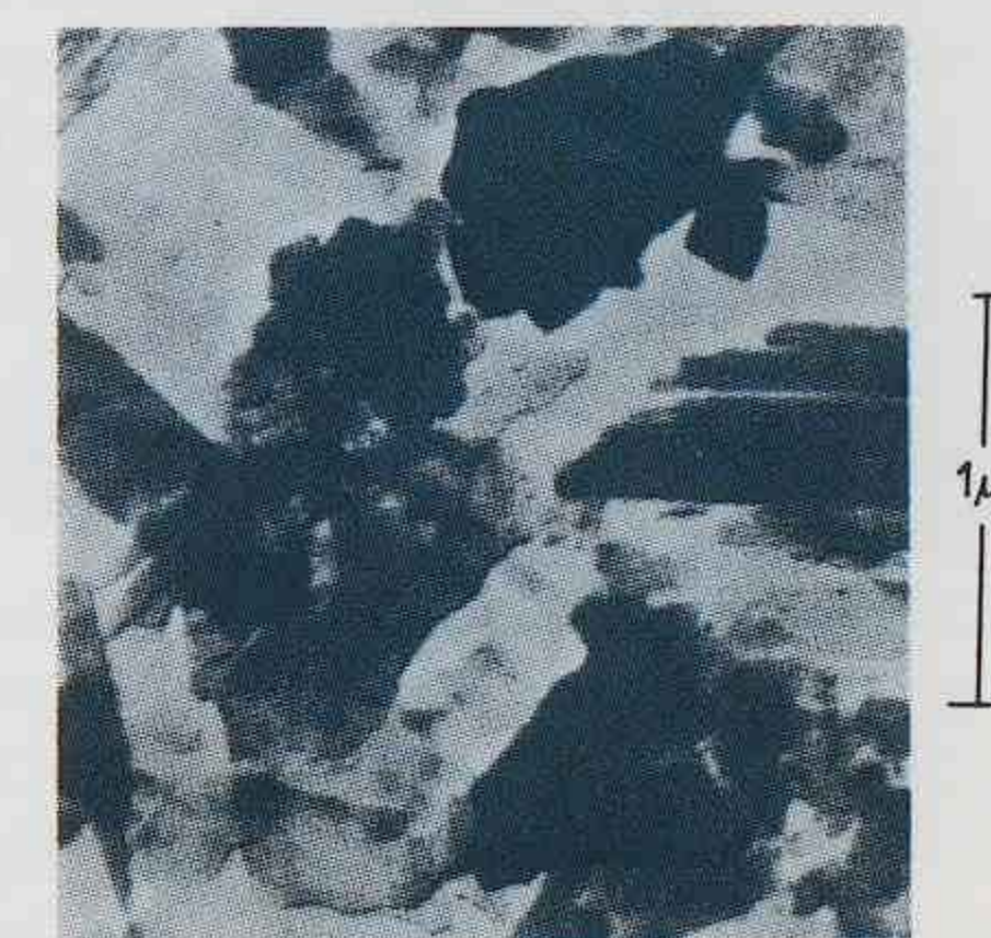
Fig. 8.- Fotografía con microscopio electrónico de cristales de illita.
